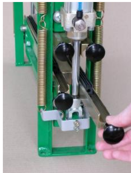
Obr.7 Vysunutí stíracího úchytu při potřebě výměny opotřebovaných stíracích lišt
