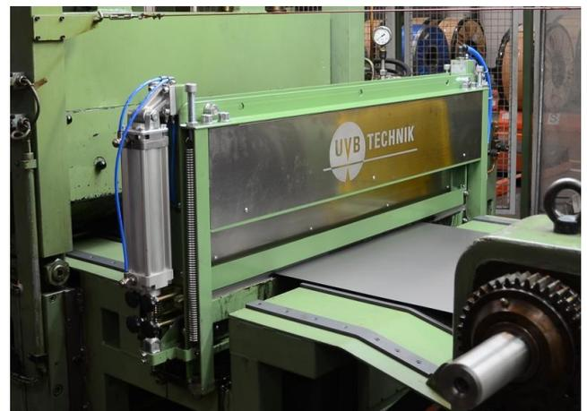
Bild Nr. 7: Abstreifvorrichtung auf der Längsteilanlage
