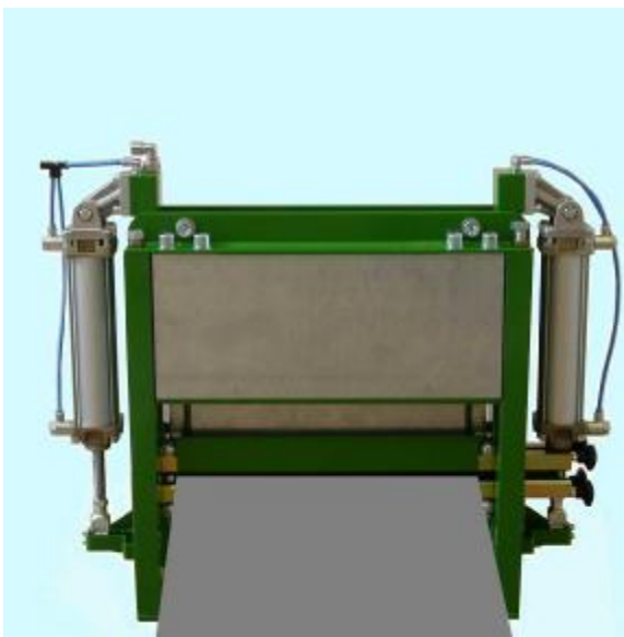
Bild Nr. 4: Abstreifvorrichtung SZ 500 in Betrieb
