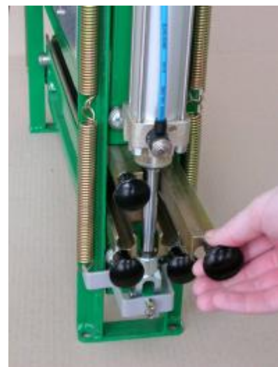
Bild Nr. 2: Ausfahren der Abstreifhalterung beim Wechseln der abgenutzten Abstreifleisten
