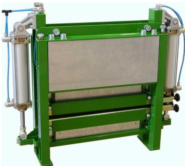
Bild Nr. 4: Abstreifvorrichtung SZ 500 in Betrieb
